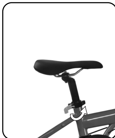
Шаг 3 Надежно закрутите эксцентрики
