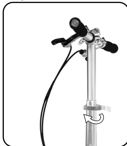
Шаг 3 Надежно закрутите эксцентрики
