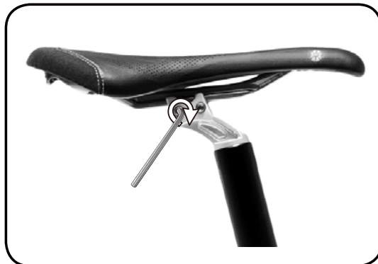
Шаг 5 - Затяните предварительно смазанные болты с моментом в 85 фунт/дюйм или 9.5 Нм.
